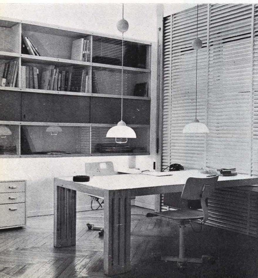
*Despacho.*—Mesa articulada de madera, con tablero forrado de sintasol. En posición normal de trabajo el tablero apoya en la pata fijada al suelo mediante bisagras y en una repisa adosada al muro. Una mesa auxiliar similar de dos patas puede ser acoplada para obtener una superficie de trabajo mayor.
